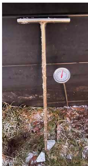
Kompostomröraren från Loftahammar har sinnrikt konstruerade vingar som viks upp när den skruvas ner i komposten och fälls ut på vägen upp. På så sätt kan det fuktiga materialet från botten lyftas upp till ytan samtidigt som allt luftas. Bredvid står en enkel analog komposttermometer med 50 cm långt spjut.
