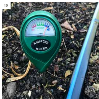
17. Med tunnor som är kopplade till varandra med slangar som är monterade i nederkanten kan "lagen om kommunicerande kärl" förflytta vatten så att ytor i de olika tunnorna till slut ställer in sig på samma höjd. 18. En enkel sticka kan användas för att mäta bevattningsbehovet i rotzonen.
